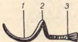
Fig. 186. Croșetul din sârmă: 1 — segmentul dentar; 2 — segmentul elastic; 3 — segmentul de fixare
