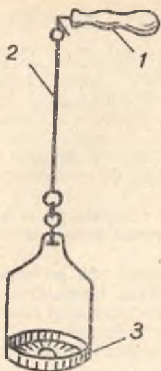
Fig. 98. Centrifuga verticală manuală: 1 — mâner; 2 — tijă; 3 — taler
