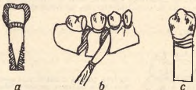
Fig. 124. Realizarea patricei din ghips: a — la modelul cu bonturi mobilizabile; b — la modelul cu bonturi fixe; c — realizarea șanțului cervical
