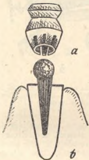
Fig. 214. Părțile componente ale capsei: a — matricea lamelată; b — dispozitivul corono-radicular cu patricea pe dinte-ancoră
