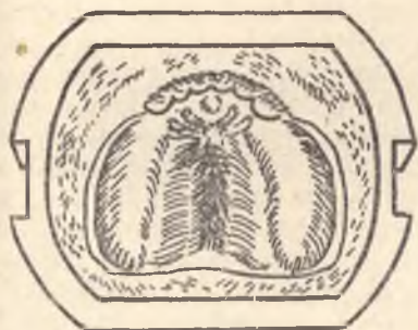
Fig. 106. Ambalarea indirectă: a — modelul cu macheta protezei mobilizabile ghipsat în jumătatea inferioară; b — tiparul obținut după topirea și înlăturarea cerii
